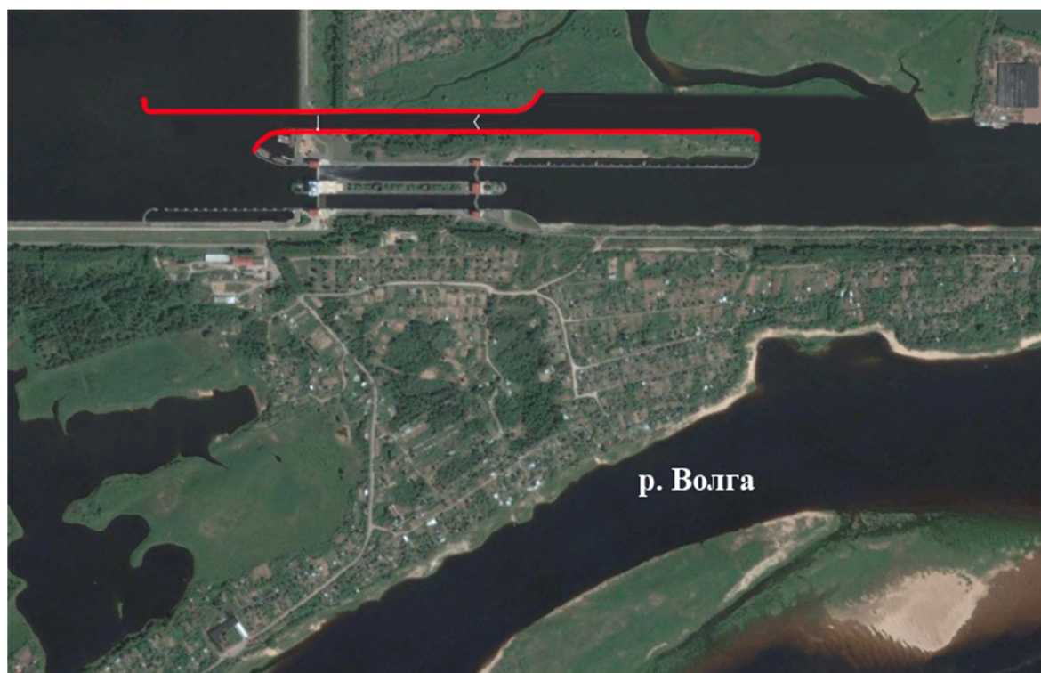
Рисунок 11. Схема строительства третьей нитки Городецкого шлюза.
