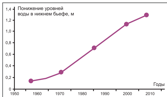
Рис. 3.11. Динамика понижения уровней воды в нижнем бьефе Горьковского гидроузла
